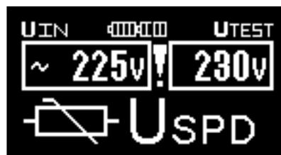
Obr. 3.4b Příklad výsledku měření (zvoleno měření přepětových ochran)
