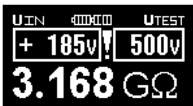
Obr. 3.7a Příklad výsledku měření (probíhá vybíjení náboje)
