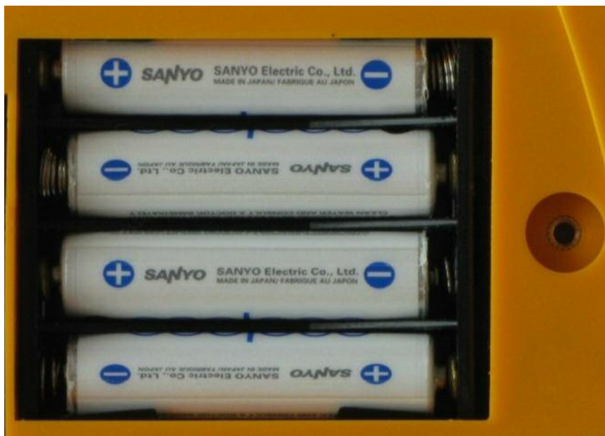
Obr. 4.1 Správná polarita napájecích článků
