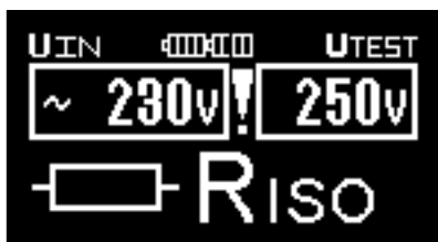
Obr. 3.4a Příklad výsledku měření (zvoleno měření izolačního odporu)
