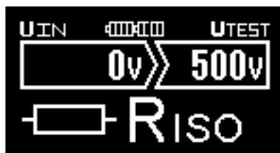
Obr. 3.5 Příklad nastavení pro měření izolačních odporů
