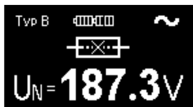
Obr. 3.2 Příklad indikace přerušené pojistky (podrobné zobrazení)
