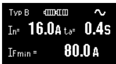
Obr. 3.16. Zobrazení min. zkratového proudu nutného pro vybavení ochrany
