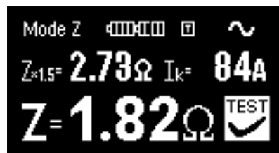
Obr. 3.8b Příklad výsledku měření impedance (podrobné zobrazení)
