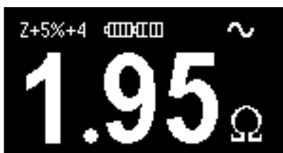
Obr. 3.11 Příklad zobrazení impedance zvýšené o chybu měření
