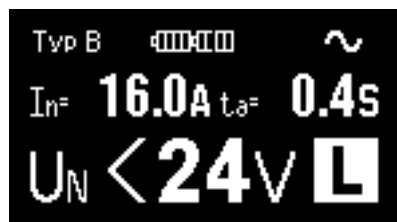
Obr. 3.17b Indikace fáze (podrobné zobrazení)
