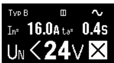
Obr. 3.4a Nízké napětí baterie (podrobné zobrazení)
