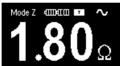
Obr. 3.8a Příklad výsledku měření impedance (stručné zobrazení)
