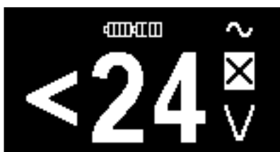
Obr. 3.1a Napětí < 24\text{ V} (stručné zobrazení)
