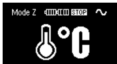
Obr. 3.6b Příklad indikace překročení max. teploty po stisku tlačítka START
