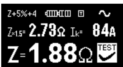
Obr. 3.13 Příklad zobrazení změřené impedance zvýšené o chybu měření
