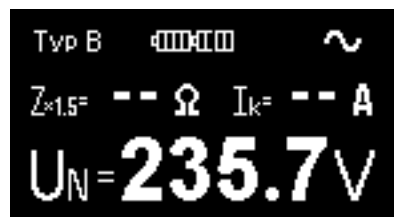
Obr. 3.3b Měření napětí (podrobné zobrazení)
