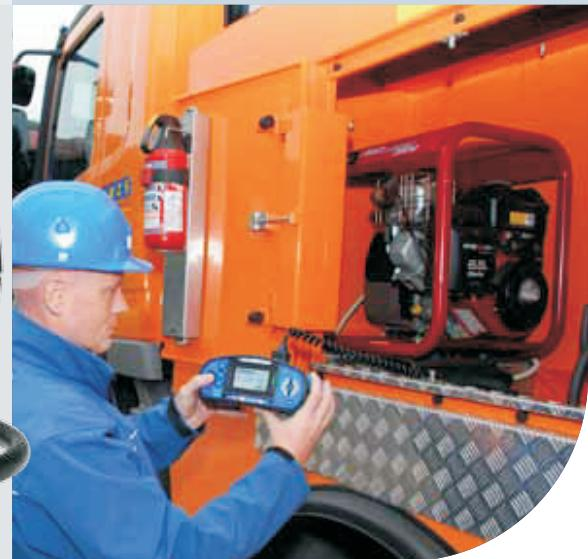
**MI 3110 EurotestIM je perfektní nástroj pro měření v pevných nebo mobilních IT instalacích AC nízkého napětí napájených z generátoru nebo transformátoru.**
