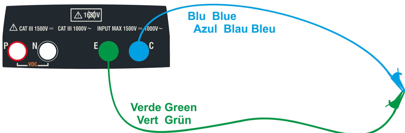
Obr. 4: Kompenzace odporu měřicích kabelů
