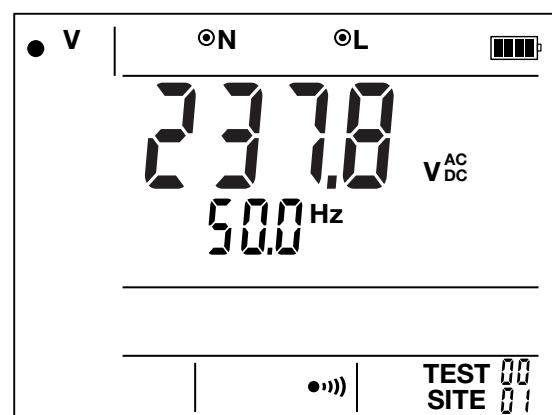
Přístroj indikuje, zda se jedná o střídavé nebo stejnosměrné napětí.
