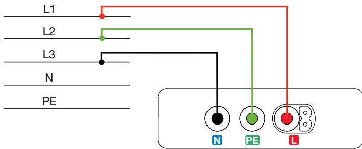
Střídavě se zobrazí sdružená napětí, každá z hodnot  $U_{12}$ ,  $U_{23}$  a  $U_{31}$  a také směr rotace fází  $L_1 \xrightarrow{L_3} L_2$  nebo  $L_1 \xleftarrow{L_2} L_2$ .
