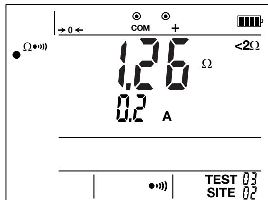
Pokud se naměřené hodnoty mění mezi hodnotou a údajem **OL**, přístroj se nevypne bez použití režimu trvalého spuštění **(P)**.
