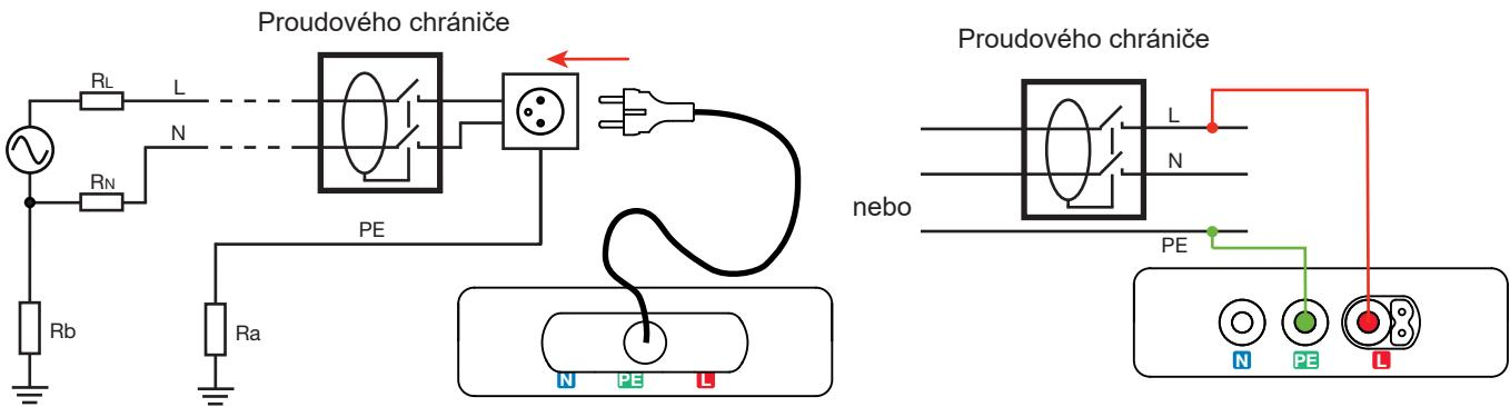
Přístroj nejprve ověří, zda je napětí mezi zdíkami **L** a **PE** správné. V tomto případě se trvale rozsvítí symbol . V opačném případě symbol bliká a není možné provést test.
