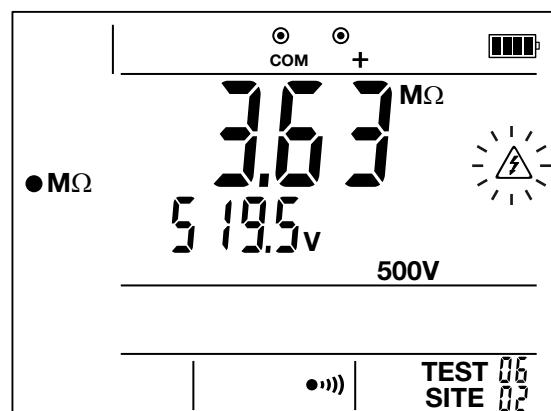
Když uvolníte tlačítko **TEST**, přístroj zobrazí údaj **DIS** (= discharge = vybití), kterým indikuje, že vybijí testovaný předmět. Pokud se nejedná o kapacitní předmět, probíhá vybíjení velmi rychle. Jestliže napětí klesne pod 25 V, na displeji se přestanou zobrazovat symboly **DIS** a .
