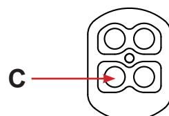
C = vstup klešťového ampérmetru
