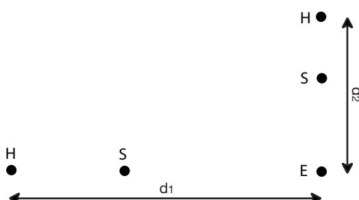
Získáte-li stejné hodnoty, vaše měření je spolehlivé. Pokud se naměřené hodnoty výrazně liší, je pravděpodobné, že bylo měření ovlivněno telurickými proudy nebo podzemní vodou. Také se může vyplatit zasunout zemnicí tyče hlouběji.
