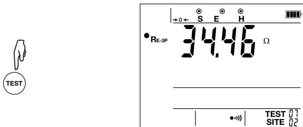
**!** Na konci měření nezapomeňte znova připojit svorkovnici uzemnění před uvedením elektroinstalace pod napětí.
