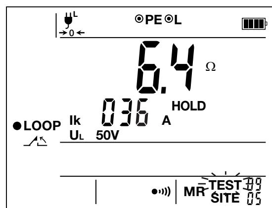
Při stisknutí tlačítka **▶** začne blikat symbol **SITE**. Pomocí tlačítka **▲** může změnit číslo oddílu.
