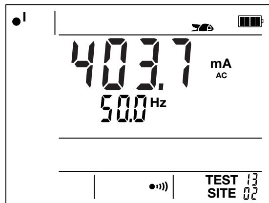
Měření proudu se provádí pouze v typu AC.
