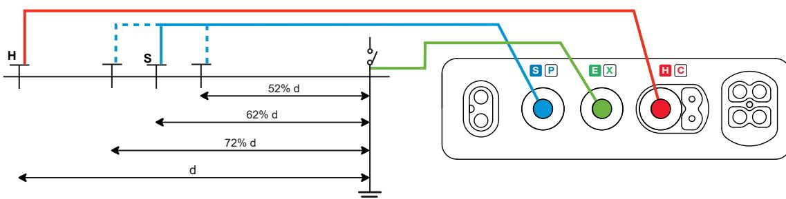
Všechny 3 výsledky měření musí být v rozpětí několika málo %. V tomto případě je naměřená hodnota platná. V opačném případě se zemnicí tyč S nachází v zóně vlivu uzemnění.
