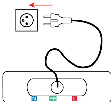
Měření se zobrazí na displeji. Přístroj indikuje, že provádí měření mezi zdířkami L a N. Je tedy možné k měření použít 2 kably.
