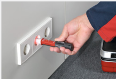
Test přítomnosti AC napětí a test polarity na zásuvkách
