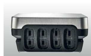
Konektory sond na spodní straně pouzdra pro čtyři termočlánky (typ T, K a J)
