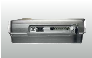
Boční připojení mini-USB kabelu a SD karty
