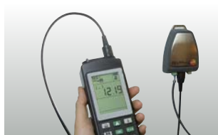
Kontrola převodníků pomocí rozhraní 4...20 mA
