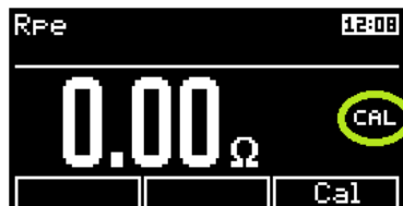
Obrázek 27: Kompenzace odporu měřicích šňůr
