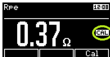
Obrázek 28: Chyba kompenzace odporu měřicích šňůr
