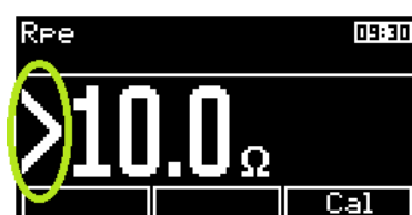
Obrázek 25: Naměřená hodnota je mimo rozsah (max)
