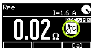
Obrázek 19: Upozornění na zahřívání vnitřních obvodů při měření Rpe
